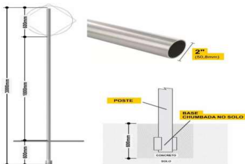
Imagem 1. Detalhes Postes Metálicos e Chumbamento. Fonte. CONTRAN, 2007.
