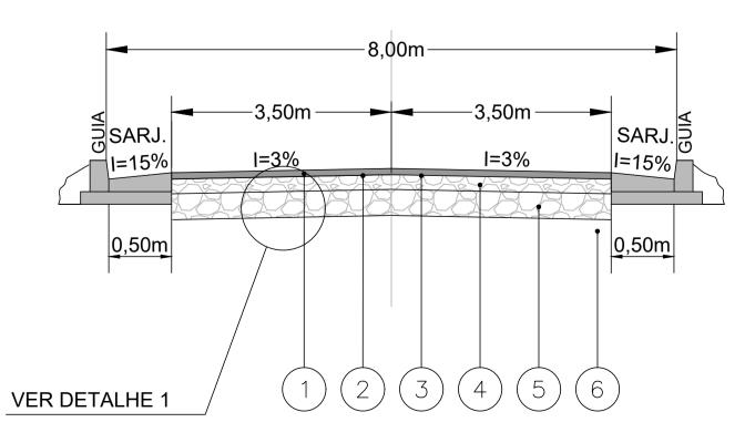
DETALHE 1 - CAMADAS DO PAVIMENTO PROJETO E DE RECOMPOSIÇÃO SEM ESCALA
