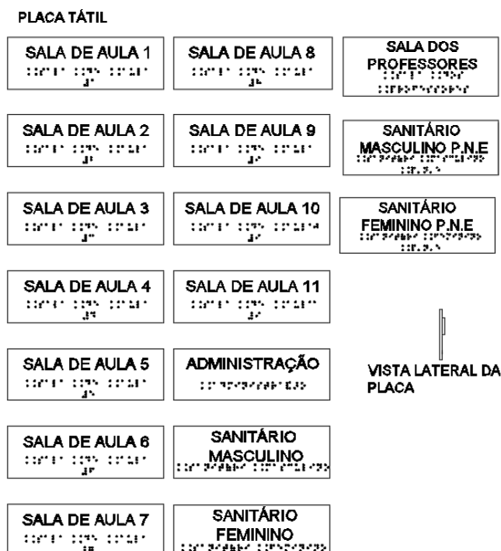
Figura 21-12 - Sinalização tátil e braile
